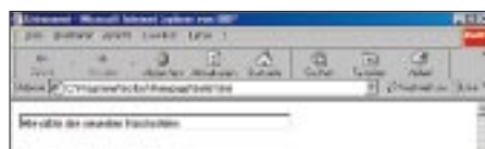
Bild 13: Im Internet-Browser erzeugt der Javascript-Ticker eine Textzeile, in welcher zyklisch der beim Erstellen der Webseite eingegebene Text angezeigt wird.
