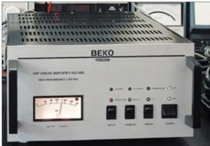
Bild 1: Frontansicht der HLV-600 während des Belastungstests mit 400W Dauersenden.
