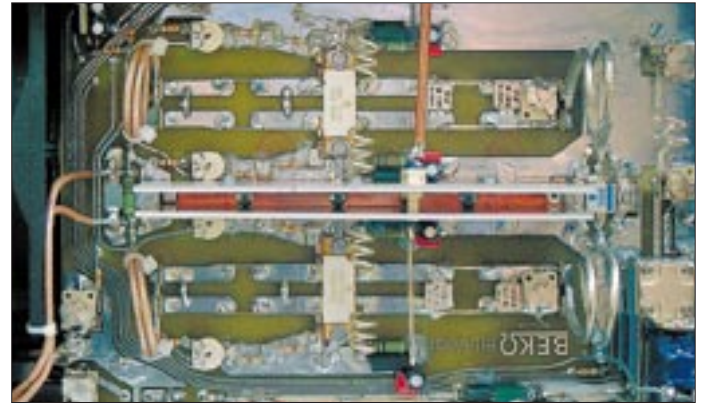
Bild 4: Innenansicht der HLV-600; links die Steuerplatine (Schutzschaltungen und Ablaufsteuerung) und Teile des Netzteils, rechts ist die Verstärkerplatine mit den beiden MOSFETs MRF-151G zu sehen.
