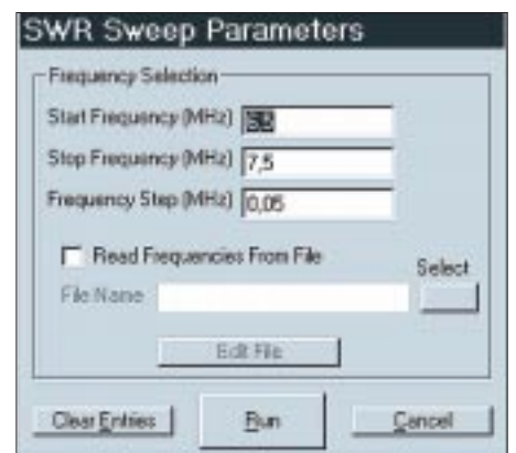
Bild 13: SWR Sweep Parameters: Eingabemaske für die Start- und Stoppfrequenzen sowie die Stufung zur Berechnung einer Wellenleitkurve s(f). Getrennt erstellte Sweepdateien (Frequenzpunktdateien) können hier ebenfalls aufgerufen werden.
