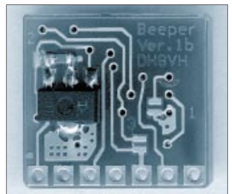
Bild 2: Die Rückseite des Moduls mit dem Spannungsregler – hier noch etwas größer
