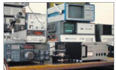
Bild 3: Meßaufbau mit TS-790; rechts im Hintergrund Spektrum-Analysator SNA-62 von W&G für die Messungen der Intermodulationsprodukte bzw. Nebenaussendungen [5].
