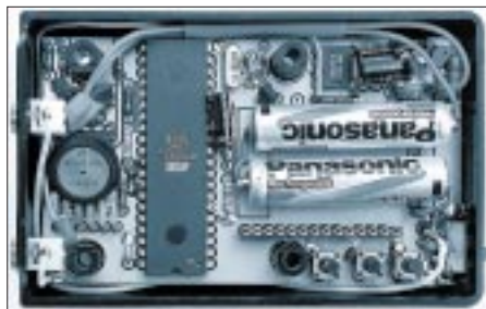
Bild 8: Die Stromversorgung wird durch zwei NiMH-AAA-Batterien realisiert.
